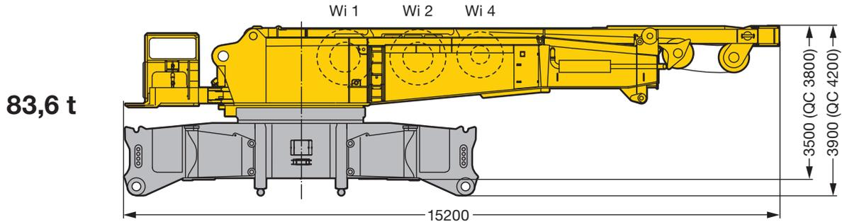
Drehbühne mit SA-Bock, Winde 4, Quick Connection,
